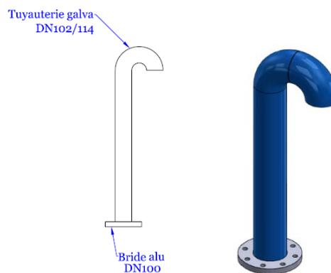
Figure 4 – Représentation schématique d'une rehausse d'évent à bride en DN 100
